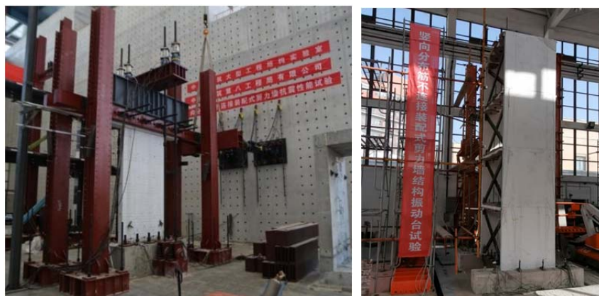
图2 足尺剪力墙构件拟静力试验与大比例子结构振动台试验
