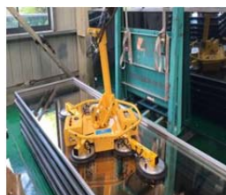
(c) 起吊安装
