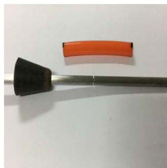
图5 改进后的预埋试验件
