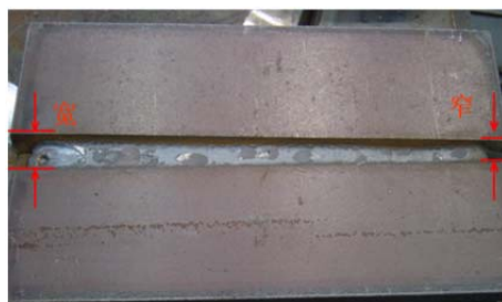
b 解决腹板顶部夹角部位的焊接
