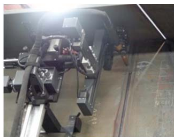
b 解决腹板顶部夹角部位的焊接
