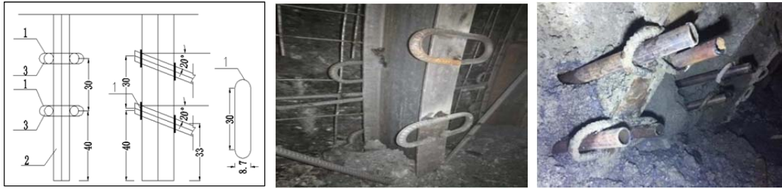
图 1：锁脚锚管（锚杆）双层定位环
