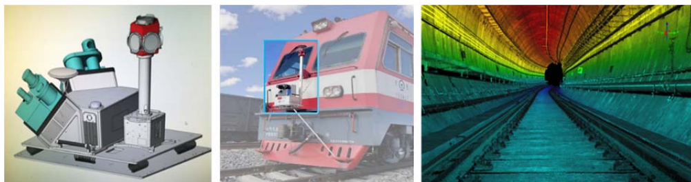
图 1 车载 LiDAR 系统、作业方式以及采集的点云数据
